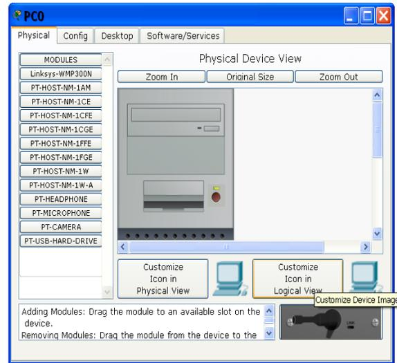
Para cambiar el módulo de conexión del dispositivo:
