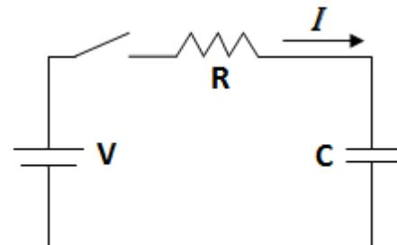
En donde **V** es el voltaje de la batería (en voltios), **R** es la resistencia (en ohmios), **C** es el valor del capacitor (en faradios), **t** es el tiempo (en segundos) luego de cerrar el interruptor y **e** es la constante de Euler (2.718281...).
