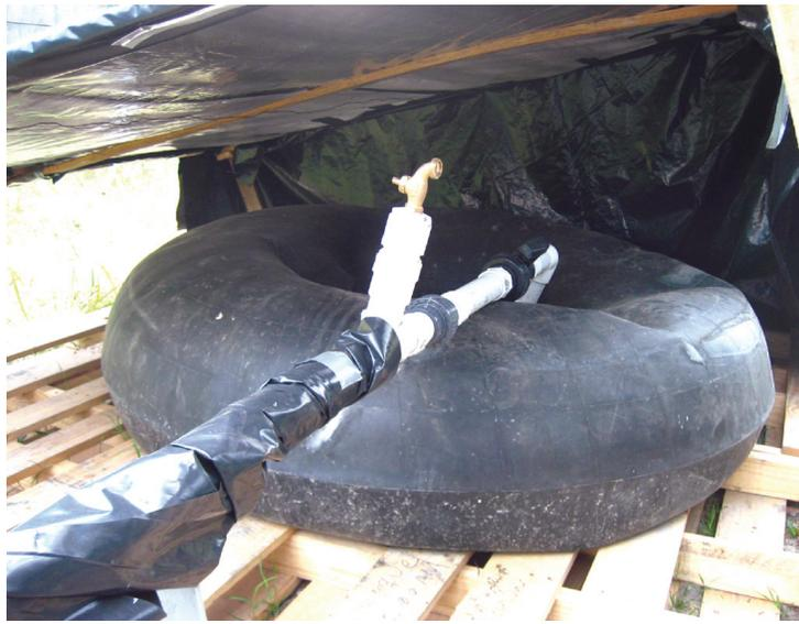
**Imagen1.** Volumen almacenado dentro del gasómetro 1.33 m<sup>3</sup>
